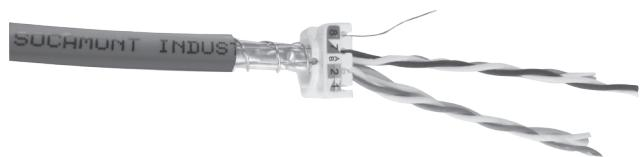
Passer les fils du câble et le drain dans le passe-fils comme montré sur la photo.
