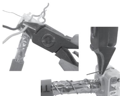
Couper les fils au raz du passe-fils et couper le drain\*.
