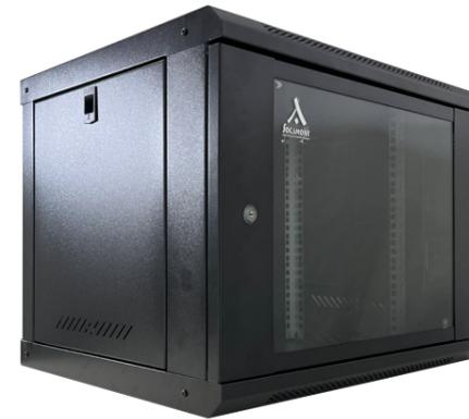
Avant de commencer le montage, il est important de déterminer l'espace nécessaire entre les montants 19" et la porte vitrée. Cet espace doit tenir compte du dépassement éventuel des matériels installés, des connecteurs nécessaires aux branchements et aussi des rayons de courbure des différents câbles. Les montants 19" peuvent être installés par pas de 25mm.
